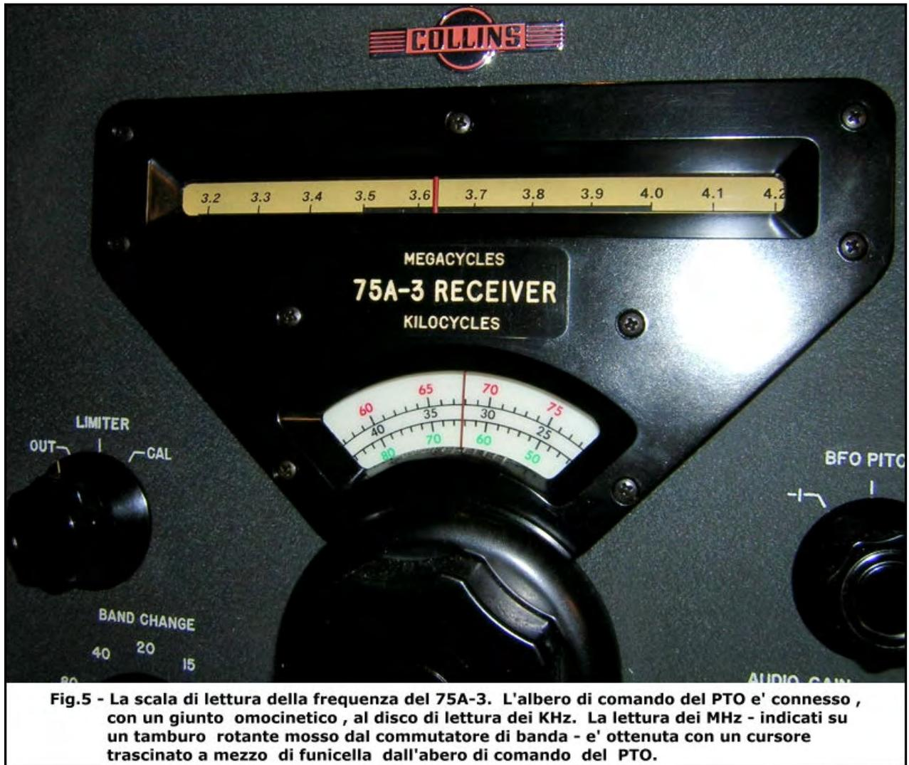
Fig.5 - La scala di lettura della frequenza del 75A-3. L'albero di comando del PTO e' connesso , con un giunto omocinetico , al disco di lettura dei KHz. La lettura dei MHz - indicati su un tamburo rotante mosso dal commutatore di banda - e' ottenuta con un cursore trascinato a mezzo di funicella dall'albero di comando del PTO.
