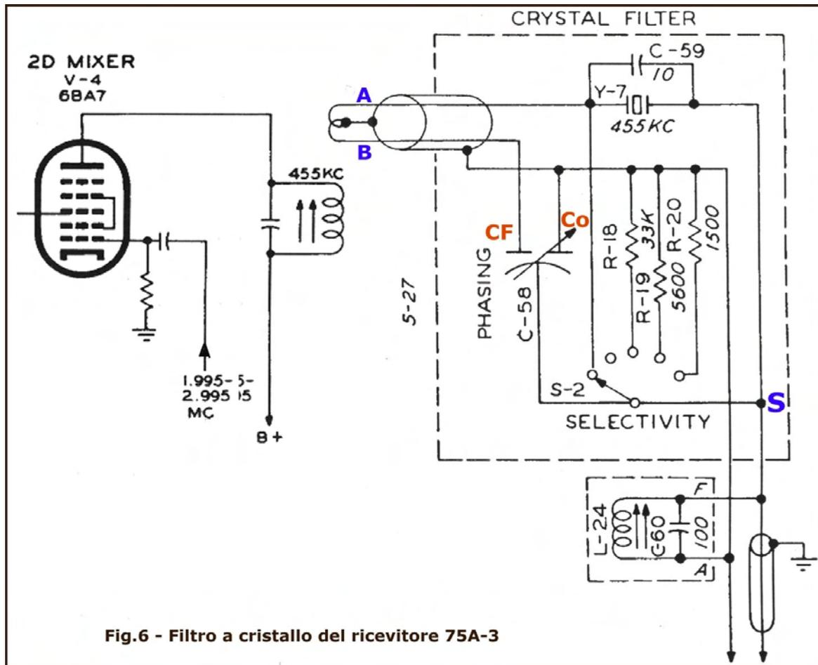
Fig.6 - Filtro a cristallo del ricevitore 75A-3
