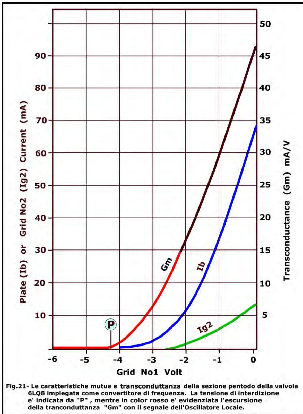
Fig.21- Le caratteristiche mutue e transconduttanza della sezione pentodo della valvola 6LQ8 impiegata come convertitore di frequenza. La tensione di interdizione e' indicata da "P", mentre in color rosso e' evidenziata l'escursione della tranconduttanza "Gm" con il segnale dell'Oscillatore Locale.
