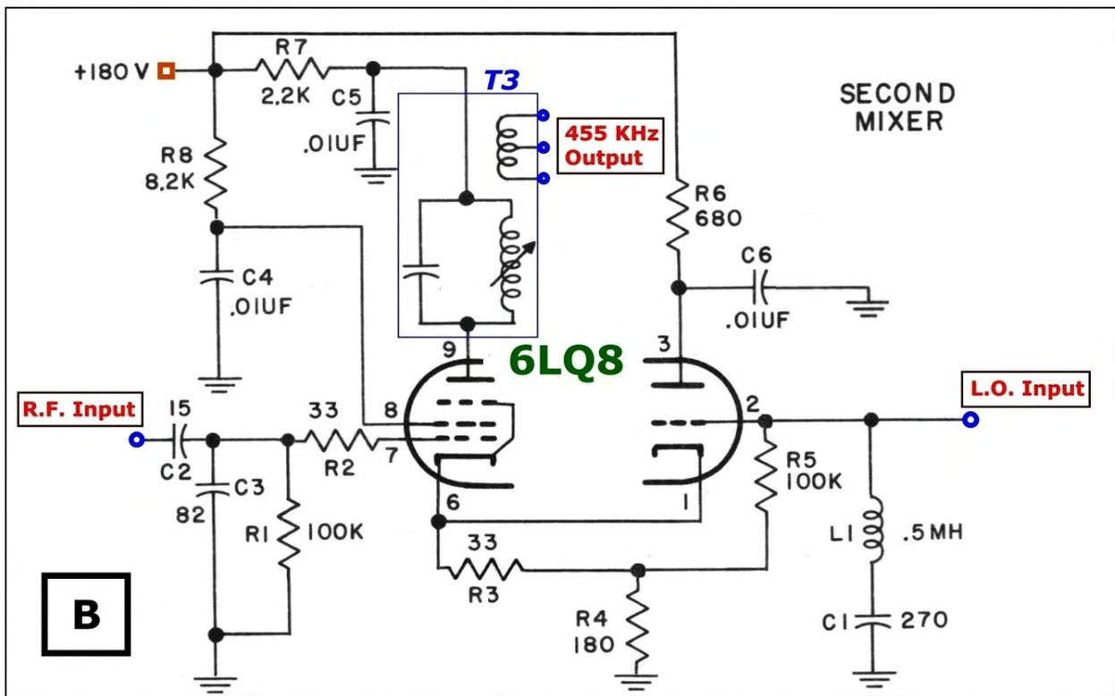
**Fig.20 - Secondo stadio mixer : A) Circuito originale , B ) Nuovo circuito**
