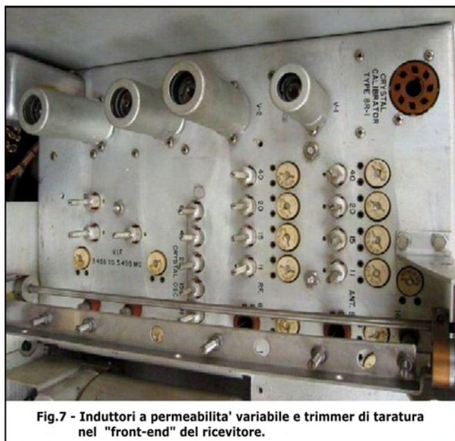
Fig.7 - Induttori a permeabilità variabile e trimmer di taratura nel "front-end" del ricevitore.
