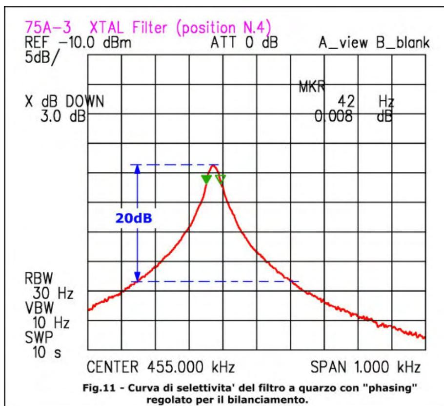
In Fig.11 osserviamo anche che i fianchi del filtro hanno pendenza di 20dB/decade : la larghezza di banda misurata @-20 dB vale 470Hz, quale appunto dovuta ad una singola coppia di poli.(semplice risonatore)
