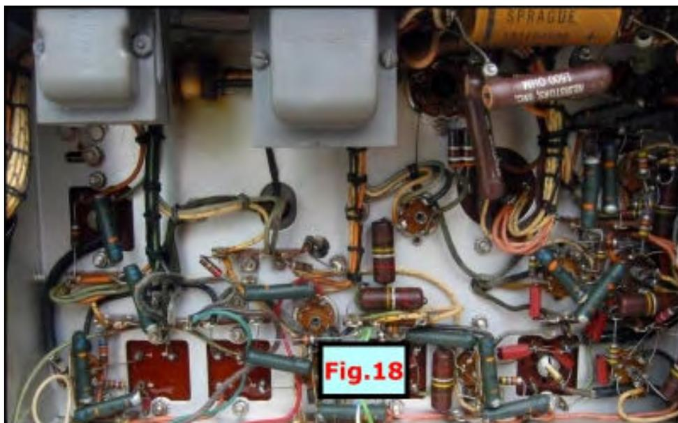
L'impiego nel secondo mescolatore di una valvola che include un pentodo ed un triodo, in sostituzione della pentagrida 6BA7, scaturisce dalle caratteristiche del **PTO** utilizzato, essendo il livello dell'oscillatore locale (**O.L.**) disponibile relativamente modesto.
