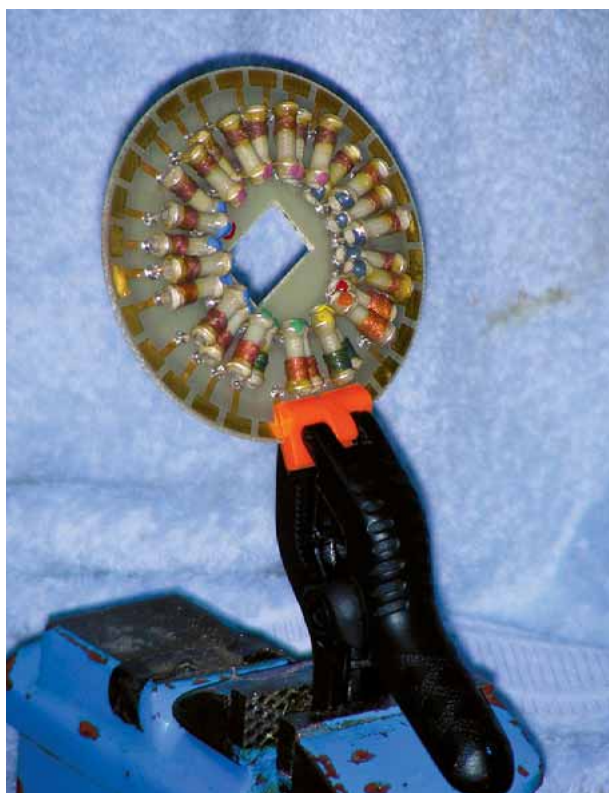
Bild 7: Einfache Halterung für Arbeiten an der Spulenscheibe
