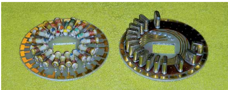
Bild 6: Zwei herausgenommene Schaltscheiben mit Spulen und Quarzen
