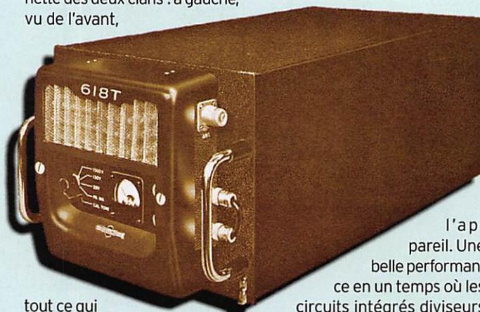
tout ce qui est à lampes, à droite rien que des transistors... Au milieu se trouve un caisson qui renferme le câblage entre les modules et répartit l'air de refroidissement propulsé par une turbine particulièrement virulente et bruyante (une plaie du 618T en service OM à moins que... voir plus bas !)
