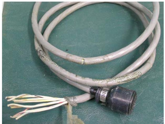
Les résistances montées avec rondelles téflon, le cordon d'alimentation sera gainé avec du thermorétractable, le collier Serflex supprimé , son état me rappelle l'époque du lapin de ma fille s'attaquant au câble du téléphone.
