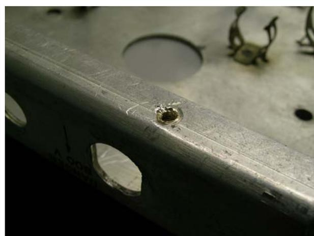
un écrou de fixation de pied est manquant, il est refait au tour, taraudage 6-32 et insertion de force dans son logement.
