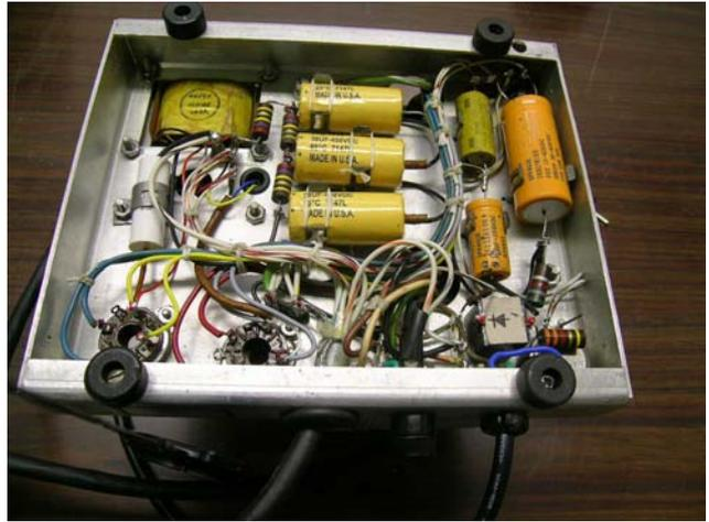
Les condensateurs 30mmF ont été remplacés, je les ai finalement gainé en jaune avec les marquages conformes à l'original. J'ai trouvé ça plus chouette ! Pas de colliers Rilsan et autres modèles en plastique, mais de la ficelle à toronner.
