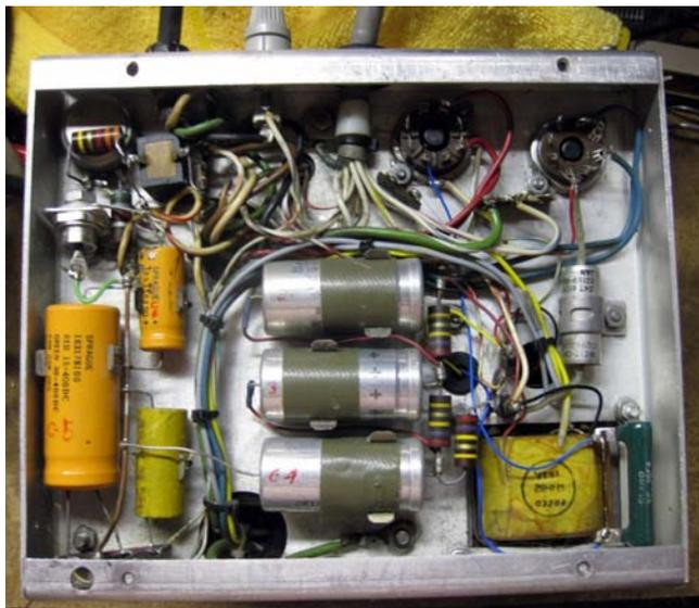
Condensateurs d'origine pour certains, tubes remplacés par du « solid state », quelques modifications bizarres, mais rien d'insoluble.
