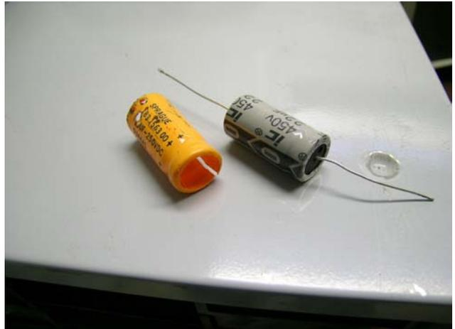
Le redresseur au selenium sera remplacé par une diode + résistance logées dans un boîtier homemade . Les enveloppe des anciens condensateurs récupérées pour gainer les nouveaux.
